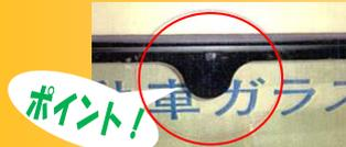
ルームミラーのステーは室内の屋根からのびています。その後ろ側にセラミックがまわり、ガラス裏面に黒いキャップ付きのボルトがある場合、接着タイプのフロントガラスとなります。
