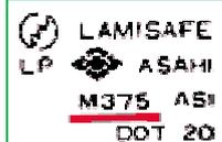
例えば、右の表記の旭硝子製のMナンバーは、375。1桁目の数字は、ガラスの品目。2桁目は品種・色。3桁目はガラスの板厚。M375のガラスは、1桁目3→合わせガラス、2桁目7→色ブルー、3桁目→板厚5mmのガラスということになります。日本板硝子の1桁目は板厚、2桁目は色、3桁目は品目となり旭硝子とは異なります。
